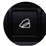
Control Electrónico de descenso
